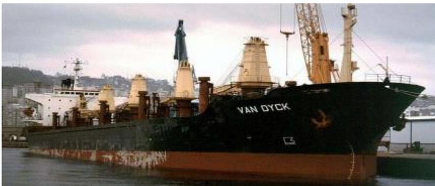
**Buque de Carga General:** Construido con una sola bahía de carga puede configurarse de varias maneras para el transporte de carga seca, se utiliza en muchos casos para transportes de grandes dimensiones y sobrepeso, contiene compartimentos para adaptar contenedores líquidos y refrigerados.
